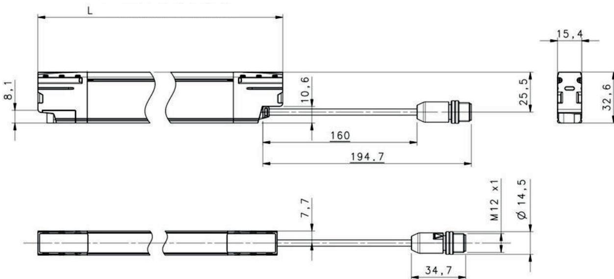
L 结构长度/保护区高度
