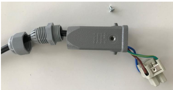
Abbildung 21: Übersicht - Verdrahtung Netzkabel mit beiliegendem Netzstecker, Schutzleiter auf Erde, Nullleiter blau auf 2, Phase braun auf 1
