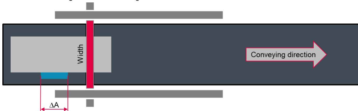
Abbildung 8: Schematische Darstellung eines Objektüberstandes in der Breite
