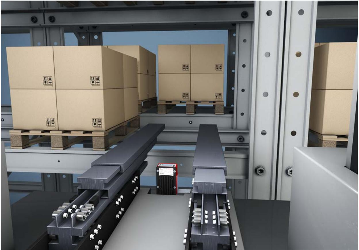
Bild 5.1: Fachfeinpositionierung eines RBG im doppeltiefen Paletten-Hochregallager
