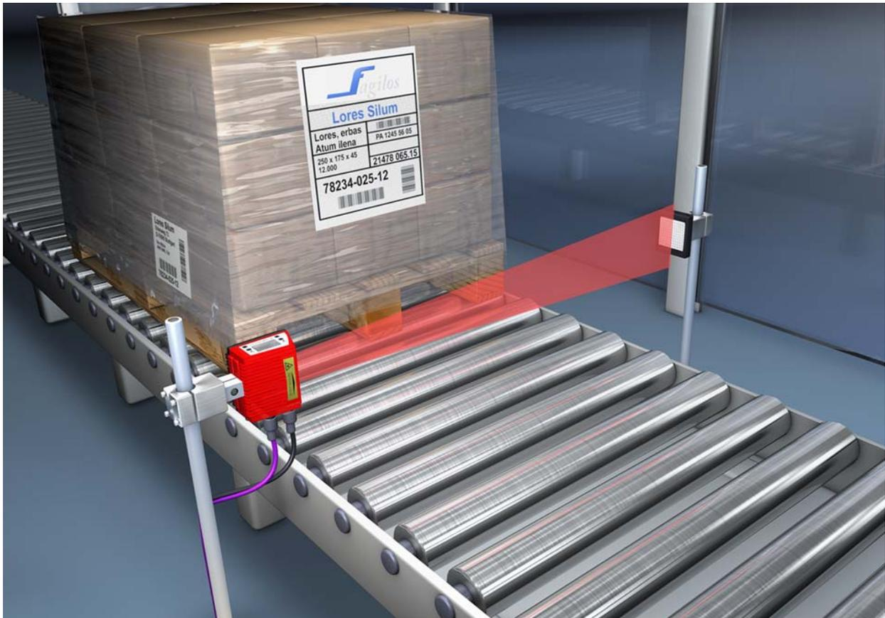
Bild 4.2: Reflektoranordnung für autoReflAct
