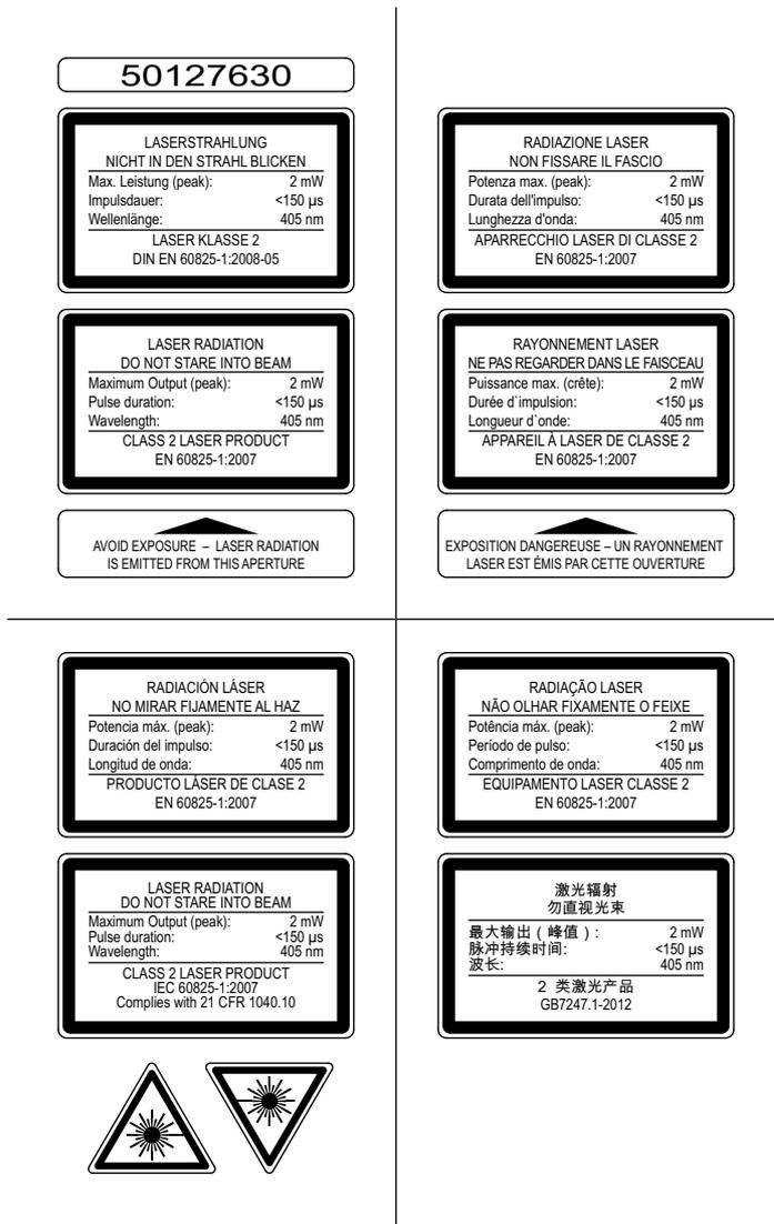
Bild 2.3: Laserwarn- und Laserhinweisschilder – beigelegte Aufkleber
