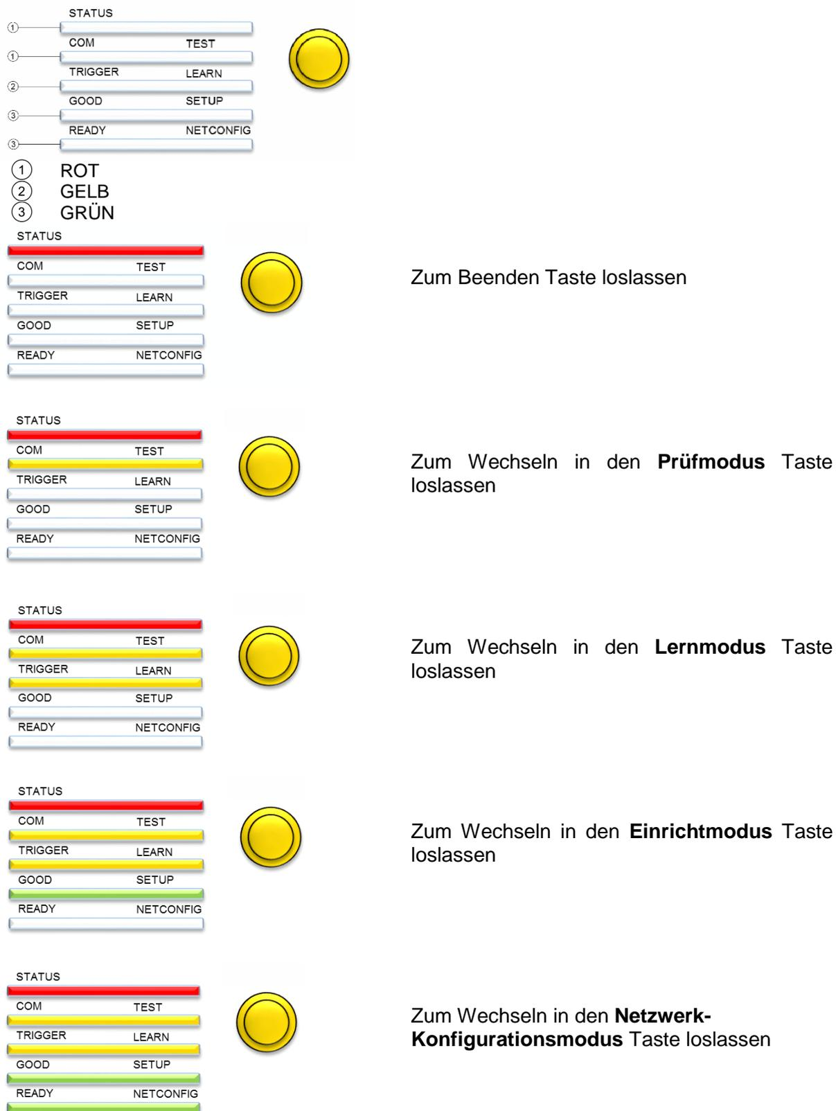
Abbildung 34: HMI-LEDs für die Betriebsarten
