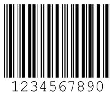
Figura 18.1: Tipo di codice 01: Interleaved 2 of 5
