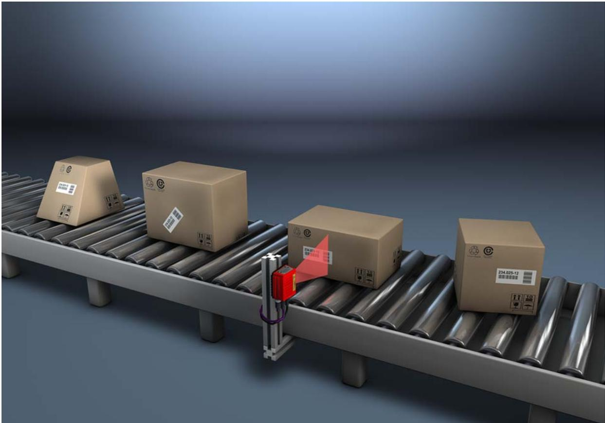
Figura 4.1: Possibile allineamento del codice a barre
