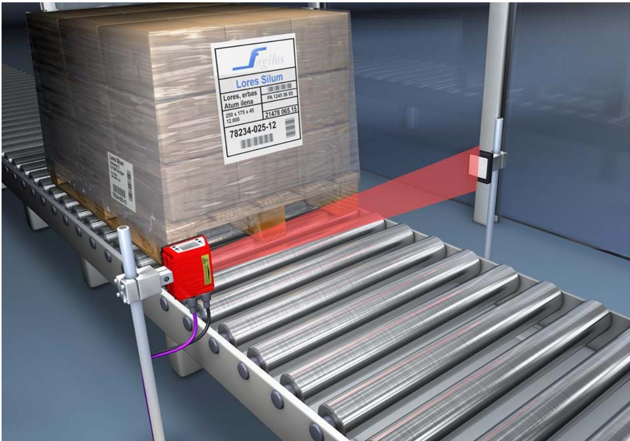
Figura 4.2: Disposición del reflector para autoReflAct
