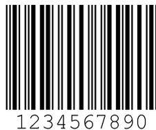
Figura 18.1: Tipo di codice 01: Interleaved 2 of 5
