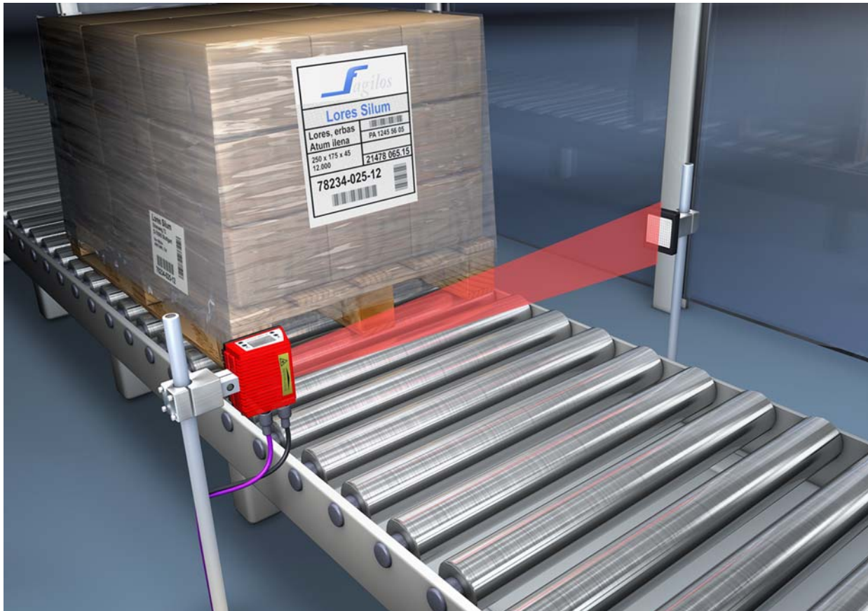
Figure 4.2 : Disposition du réflecteur pour l'autoReflAct
