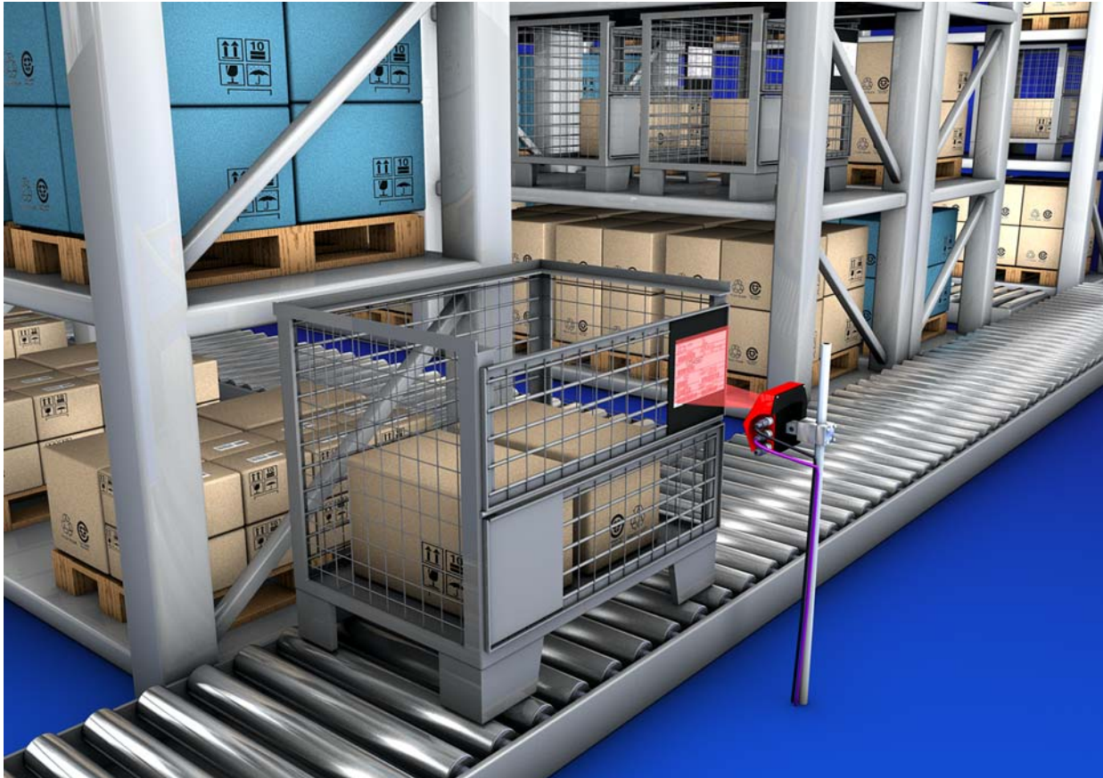
Figure 5.2 : Principe de déviation du scanner monotrame équipé d'un miroir pivotant
