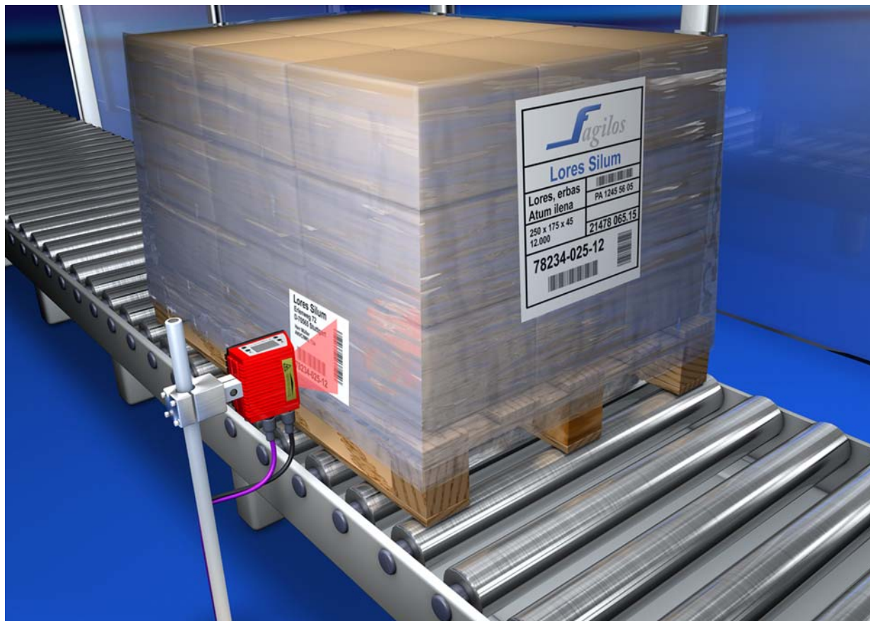
Figura 5.1: Principio de barrido del escáner lineal
