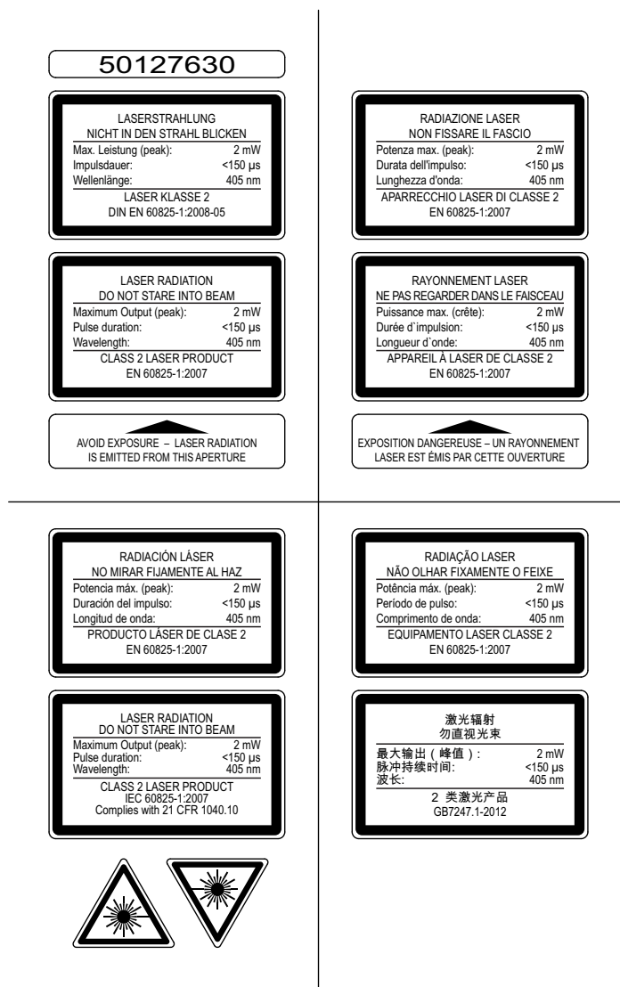
Figura 2.3: Placas de advertencia de láser y de aviso de láser – etiquetas adhesivas incluidas
