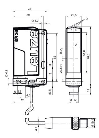
A TrasmettitoreC Asse otticoDA LED verde
