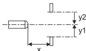
Réaction typ. (distance de réglage 1300 mm)
