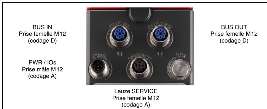
Figure 7.1 : Raccordements de l'AMS 358*i*
