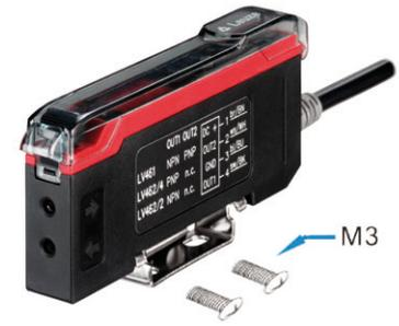
L'amplificatore viene montato come raffigurato su una guida di montaggio TS 35 a tensione disinserita.
