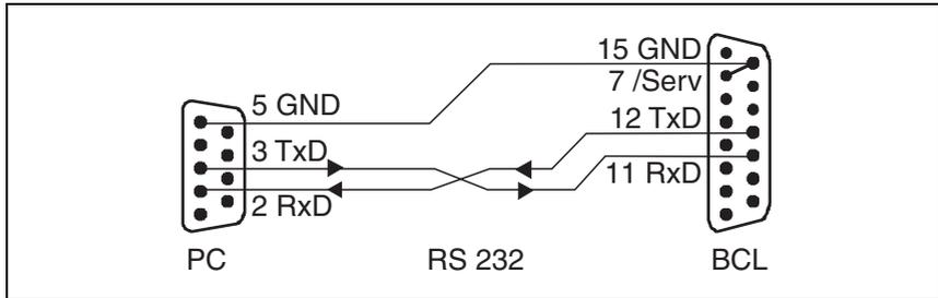
Bild 7.1: Verbindung der Service-Schnittstelle mit PC oder Terminal
