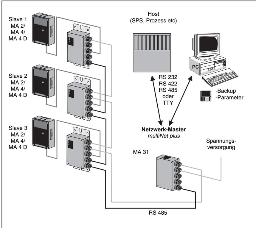
Bild 3.2: Vernetzungsmöglichkeiten über multiNet plus (BCL 31)
