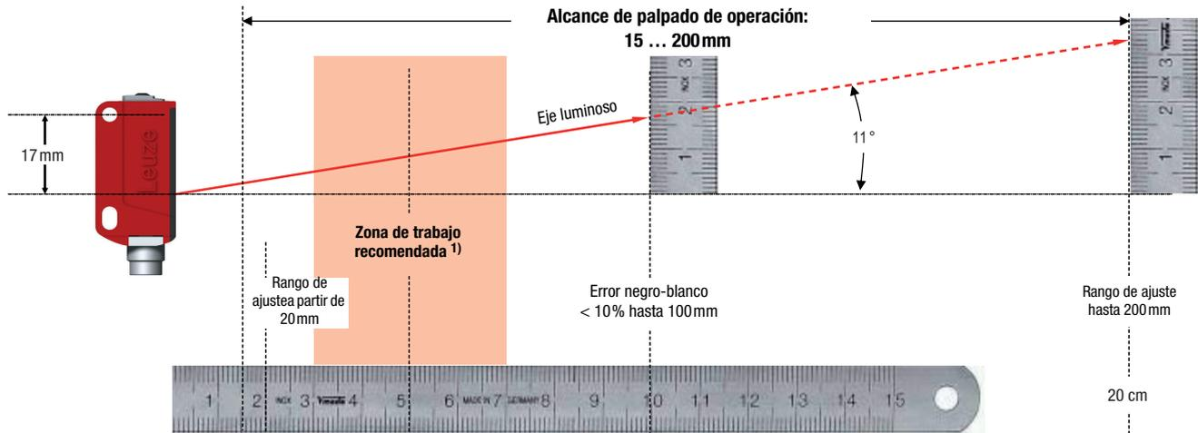
1) En la zona de trabajo recomendada es donde mayor es la capacidad de un sensor para detectar con seguridad una superficie reflectante o un objeto transparente. No obstante, el sensor también puede detectar de forma segura este tipo de objetos en todo el área del alcance de palpado de operación, si bien con una reserva de función reducida en comparación con la zona de trabajo recomendada.
