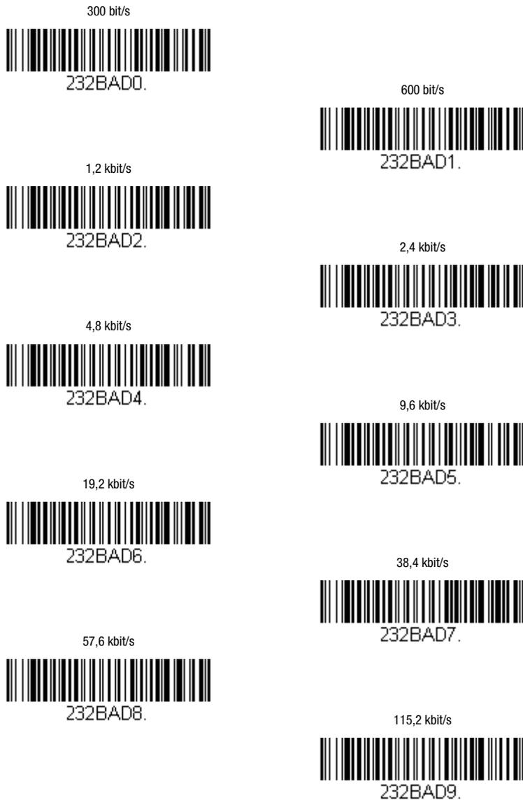
Figura 7.2: Codici di parametrizzazione, velocità di trasmissione RS 232
