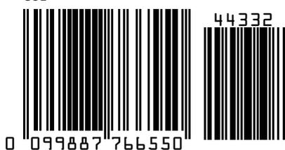
Figura 13.2: Modello di codice a barre (modulo 0,5)
