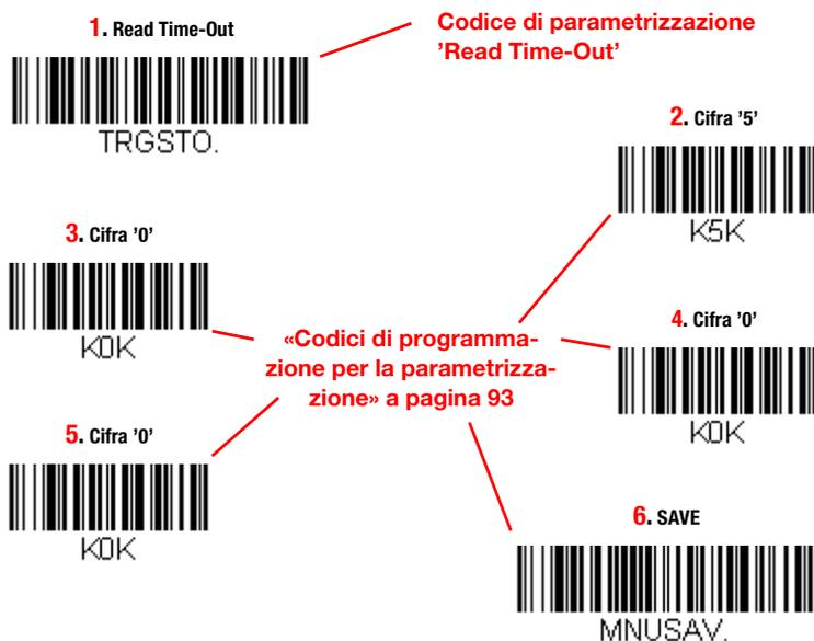
Figura 7.8: Esempio: impostazione di un tempo Read Time-Out di 5 secondi
