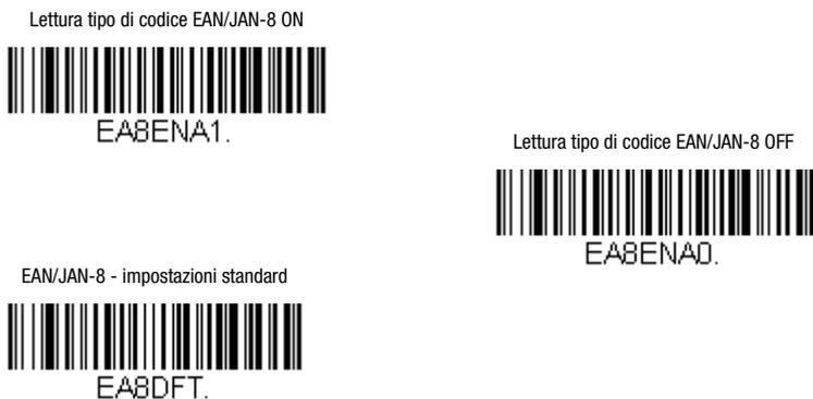
Figura 7.36: Codici di parametrizzazione per attivare/disattivare il tipo di codice EAN/JAN-8
