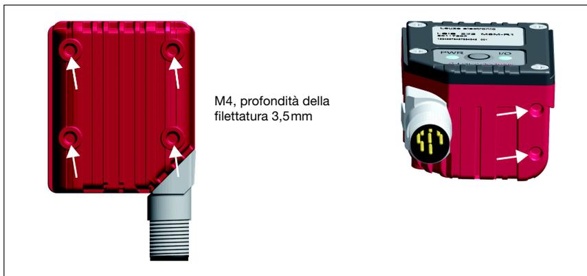
Figura 4.2: Possibilità di fissaggio mediante fori filettati M4x6
