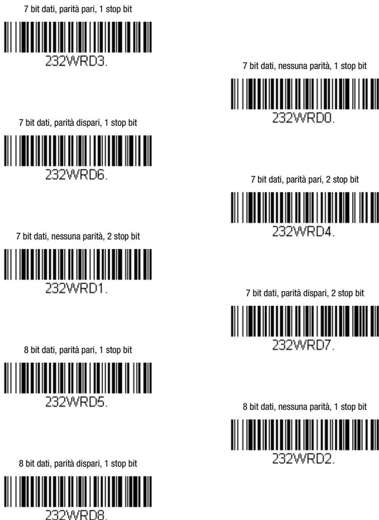
Figura 7.3: Codici di parametrizzazione, formato dei dati RS 232
