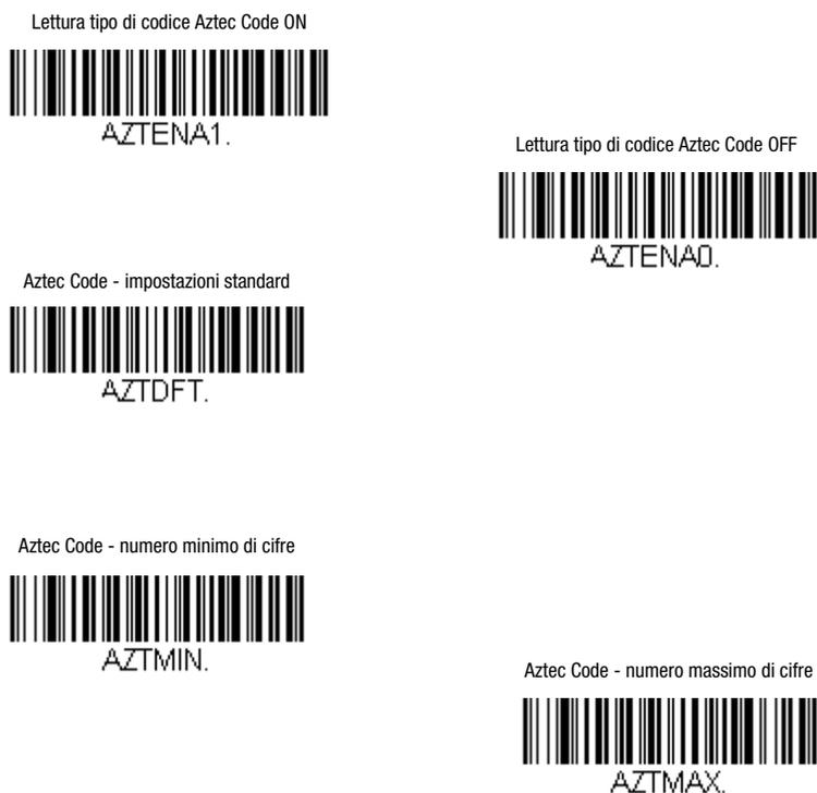
Figura 7.46: Codici di parametrizzazione per attivare/disattivare il tipo di codice Aztec Code
