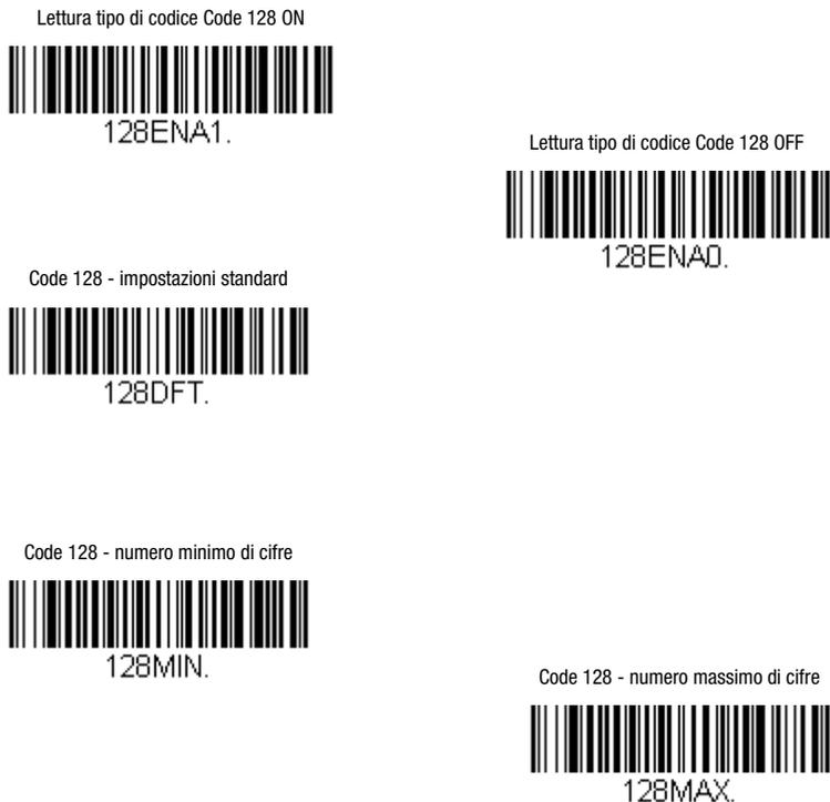
Figura 7.30: Codici di parametrizzazione per attivare/disattivare il tipo di codice Code 128
