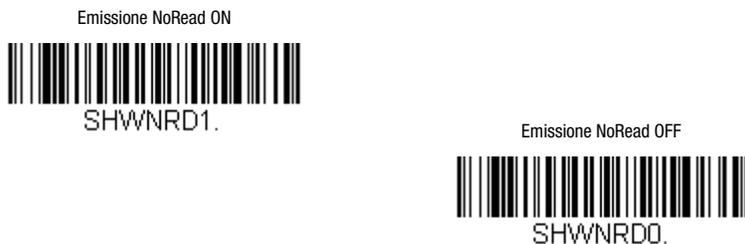
Figura 7.21: Codici di parametrizzazione per l'attivazione/disattivazione dell'opzione Emissione NoRead
