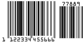
Figura 13.1: Modello di codice a barre (modulo 0,3)
