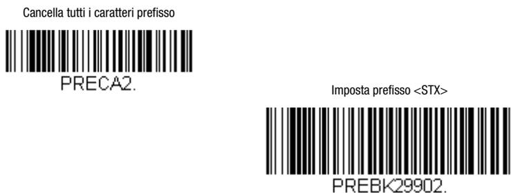
Figura 7.19: Codici di parametrizzazione per l'impostazione del prefisso
