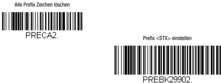
Bild 7.19: Parametriercodes zum Einstellen des Prefix
