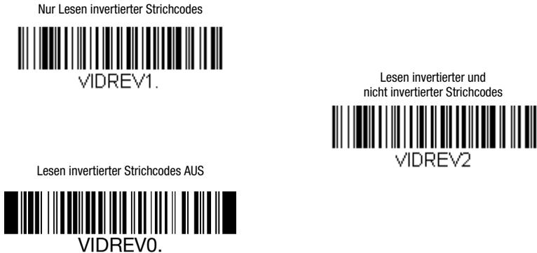
Bild 7.17: Parametriercodes zum Ein-/Ausschalten der Option Video Reverse
