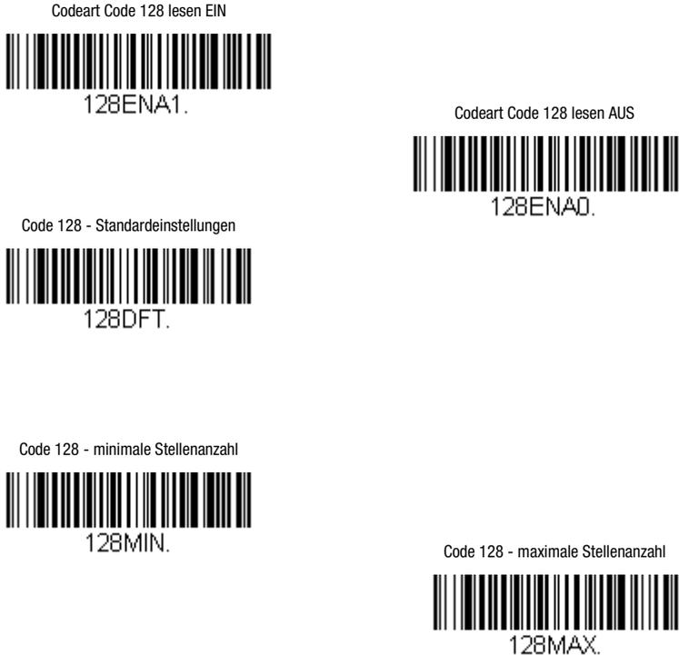
Bild 7.30: Parametriercodes zum Aktivieren/Deaktivieren der Codeart Code 128
