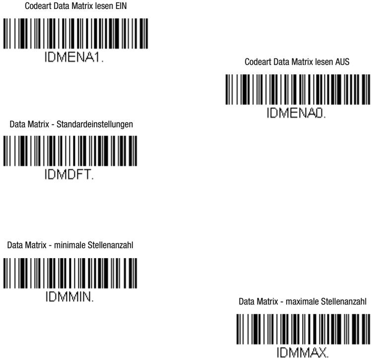
Bild 7.44: Parametriercodes zum Aktivieren/Deaktivieren der Codeart Data Matrix
