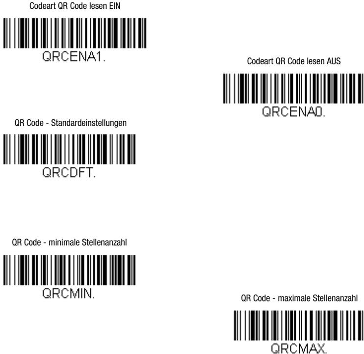
Bild 7.43: Parametriercodes zum Aktivieren/Deaktivieren der Codeart QR Code
