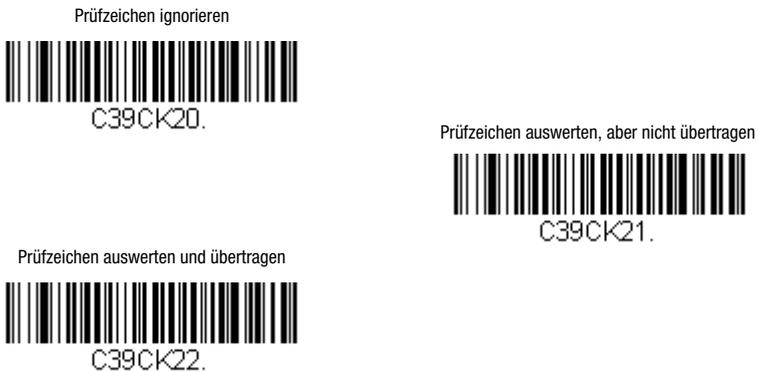
Bild 7.25: Parametriercodes zur Behandlung des Prüfzeichens beim Code 39
