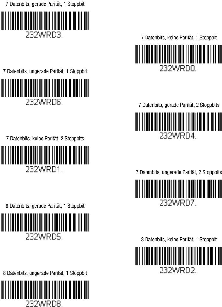
Bild 7.3: Parametriercodes RS 232 Datenformat
