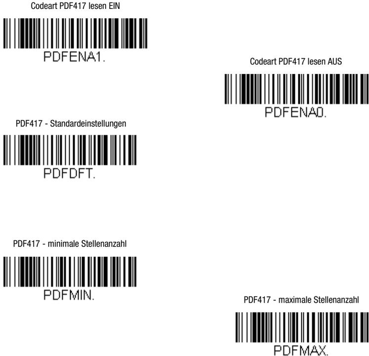
Bild 7.40: Parametriercodes zum Aktivieren/Deaktivieren der Codeart PDF417
