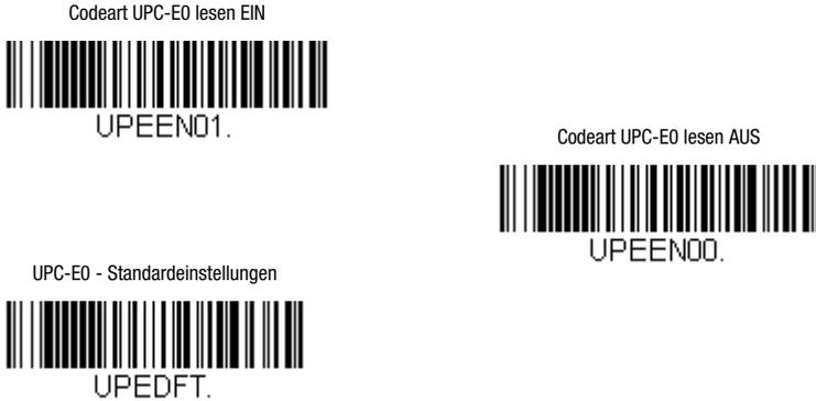
Bild 7.33: Parametriercodes zum Aktivieren/Deaktivieren der Codeart UPC-E0
