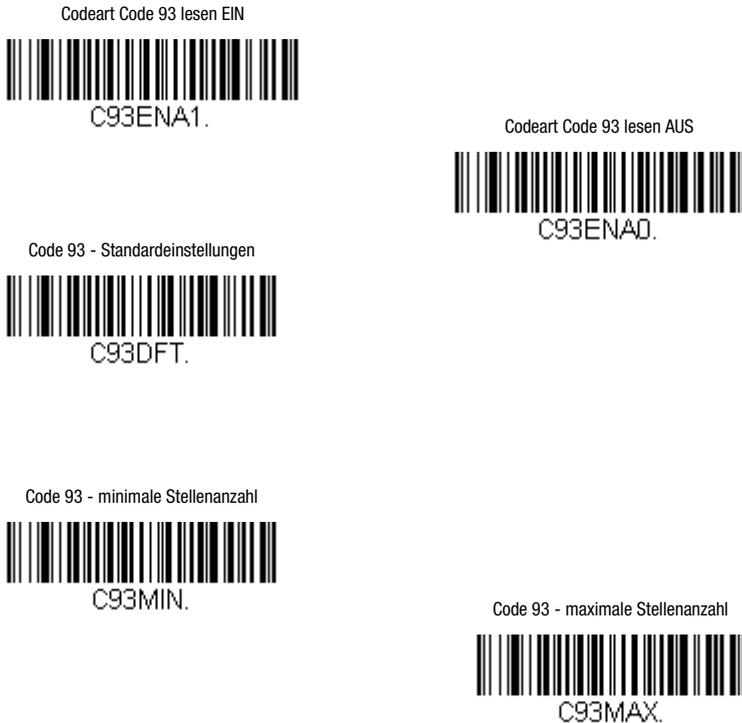
Bild 7.29: Parametriercodes zum Aktivieren/Deaktivieren der Codeart Code 93
