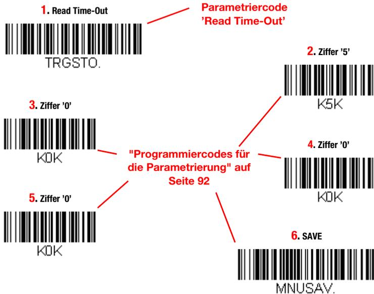
Bild 7.8: Beispiel: Einstellung einer Read Time-Out Zeit von 5 Sekunden
