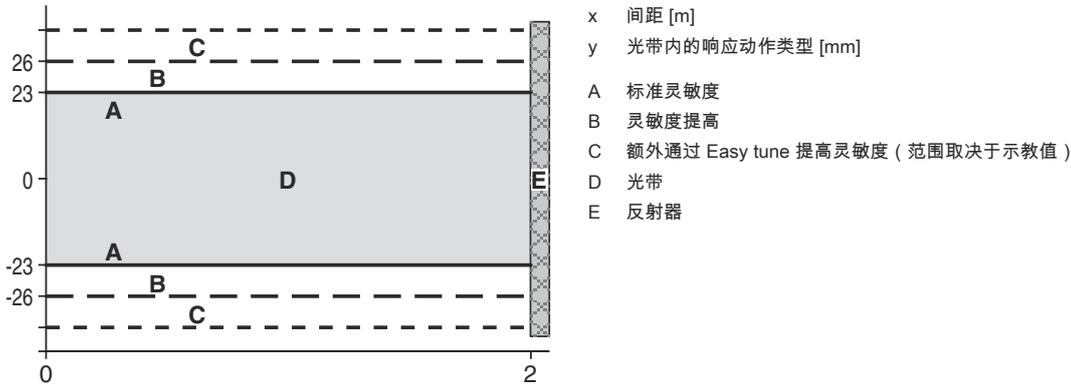
探测的参考物体：12 mm 带反射器 TKS 40x60
