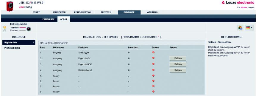
Bild 3.67: Modul "Diagnose", Register "Gerät" -Digitale I/Os
