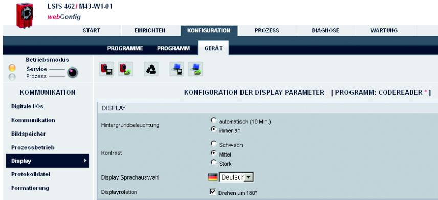
Bild 3.59: Modul "Konfiguration", Register "Gerät" – Display
