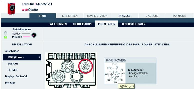
Klick auf die maussensitive **Pinbelegungs**darstellung öffnet das entsprechende **Konfigurationsfenster**
