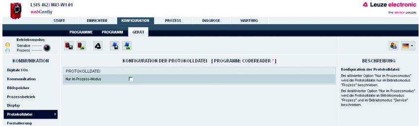
Bild 3.60: Modul "Konfiguration", Register "Gerät" – Protokolldatei
