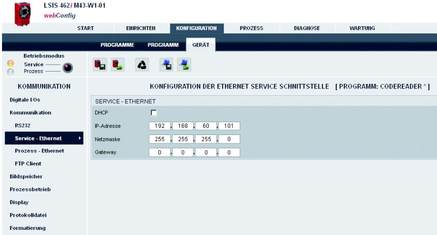
Bild 3.54: Modul "Konfiguration", Register "Gerät" – Kommunikation "Service - Ethernet"
