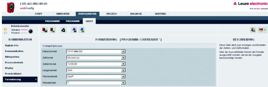
Bild 3.61: Modul "Konfiguration", Register "Gerät" – Formatierung
