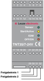
**Bild 5.2-7:** Verdrahtung Sicherheitsausgang (2-kanaliger Freigabekreis)
