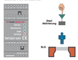
Bild 5.4-2: Anzeige des TNT 35/7-24V im Testbetrieb
