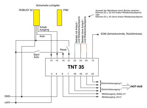
Bild 6.4-1: Anschlussbild bei Anschluss eines ROBUST 22
