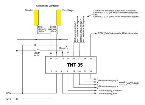
Bild 6.3-1: Anschlussbild bei Anschluss eines Paares ECO
