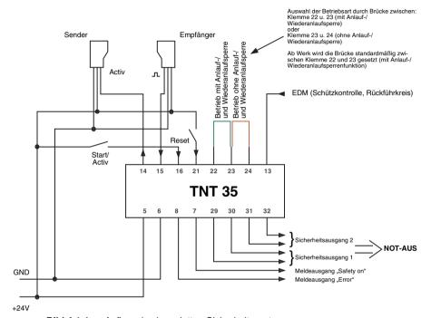
Bild 4.1-1: Aufbau des kompletten Sicherheitssystems
