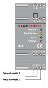
**Bild 4.2-7:** Verdrahtung Sicherheitsausgang (2-kanaliger Freigabekreis)
