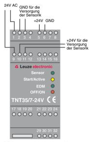
Bild 5.2-1: Verdrahtung Versorgung
