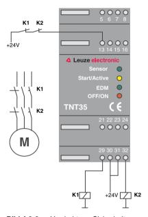
Bild 4.2-8: Verdrahtung Sicherheitsausgang mit Schützkontrolle
