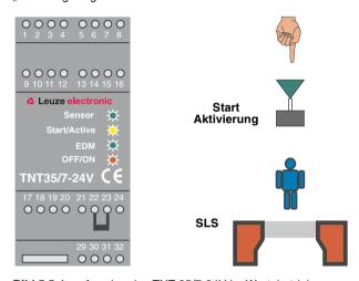
Bild 5.5-1: Anzeige des TNT 35/7-24V im Wartebetrieb
