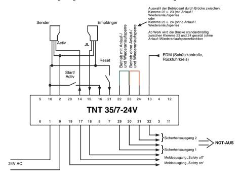
Bild 5.1-1: Aufbau des kompletten Sicherheitssystems
