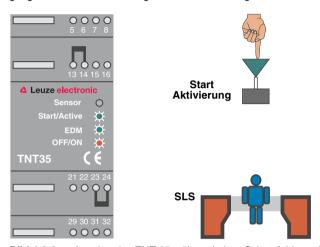
Bild 4.3-3: Anzeige des TNT 35 während einer Schutzfeldunterbrechung
