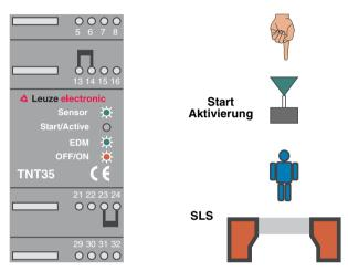
Bild 4.3-1: Anzeige des TNT 35 im Wartebetrieb
