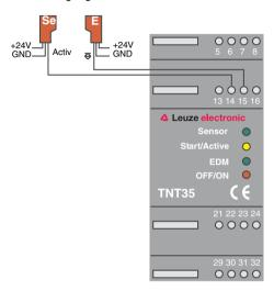
Bild 4.2-4: Verdrahtung von Einstrahl-Sicherheits-Lichtschranken
