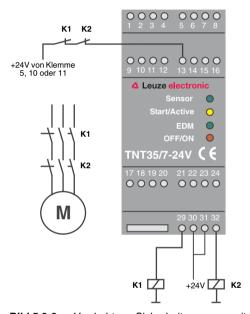
Bild 5.2-8: Verdrahtung Sicherheitsausgang mit Schützkontrolle
