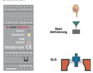
Bild 5.5-4: Anzeige des TNT 35/7-24V während einer Schutzfeldunterbrechung
