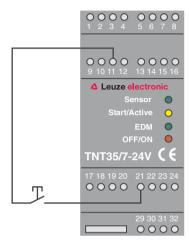
Bild 5.6-1: Lösen der Verriegelung
