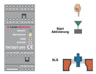
Bild 5.4-4: Anzeige des TNT 35/7-24V während einer Schutzfeldunterbrechung
