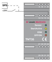
Bild 4.2-3: Verdrahtung Start-Eingang "ohne Anlauf- und Wiederanlaufsperre"
