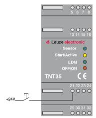
Bild 4.6-1: Lösen der Verriegelung
