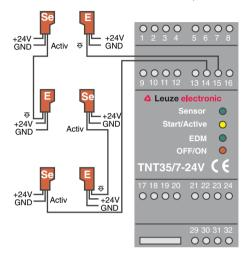
**Bild 5.2-5:** Verdrahtung von Einstrahl-Sicherheits-Lichtschranken in Reihenschaltung
