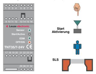
Bild 5.3-1: Anzeige des TNT 35/7-24V im Wartebetrieb
