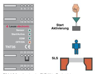
Bild 4.5-2: Anzeige des TNT 35 im Testbetrieb
