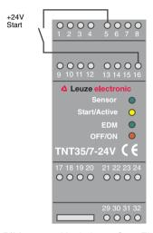
Bild 5.2-3: Verdrahtung Start-Eingang "ohne Anlauf- und Wiederanlaufsperre"
