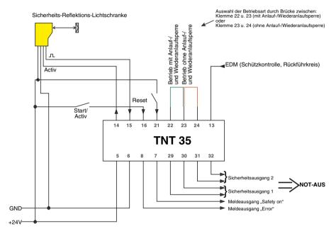
Bild 6.1-1: Anschlussbild bei Anschluss einer SRK 96
