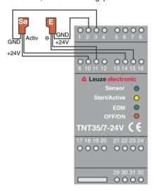
Bild 5.2-4: Verdrahtung von Einstrahl-Sicherheits-Lichtschranken
