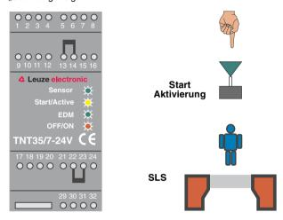
Bild 5.4-1: Anzeige des TNT 35/7-24V im Wartebetrieb
