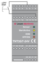
Bild 5.2-2: Verdrahtung Start-Eingang "mit Anlauf- und Wiederanlaufsperre"
