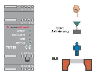
Bild 4.5-3: Anzeige des TNT 35 im Schutzbetrieb
