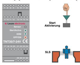
Bild 5.3-3: Anzeige des TNT 35/7-24V während einer Schutzfeldunterbrechung
