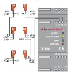
**Bild 4.2-5:** Verdrahtung von Einstrahl-Sicherheits-Lichtschranken in Reihenschaltung
