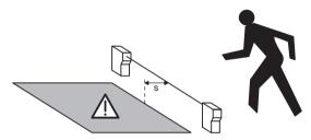
Bild 3.1-1: Sicherheitsabstand S zwischen Lichtschranke und Gefahrenbereich
