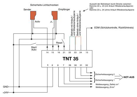
Bild 6.2-1: Anschlussbild bei Anschluss eines Paares SI S 96
