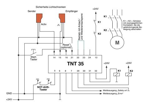
Bild 6.5-1: Anschlussbild mit Sicherheits-Lichtschranke SLS 96 und NOT-AUS-Funktion
