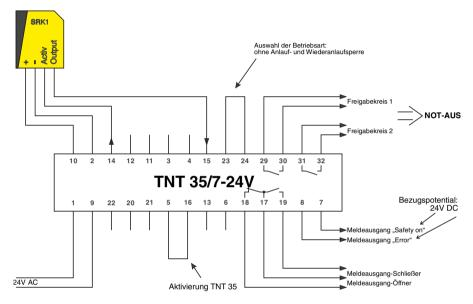
Bild 6.6-1: Anschlussbild bei Anschluss einer SRK 96
