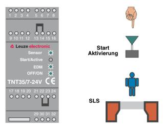
Bild 5.4-3: Anzeige des TNT 35/7-24V im Schutzbetrieb
