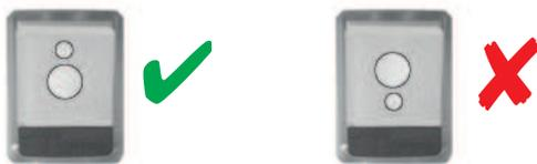
Fig. 6.23: Orientation du film diffuseur
