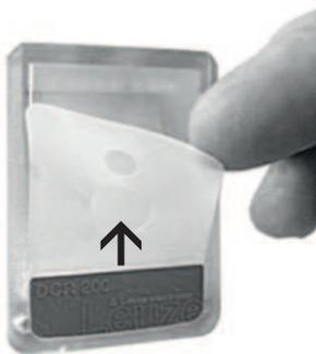
Fig. 6.24: Appliquer le film diffuseur
