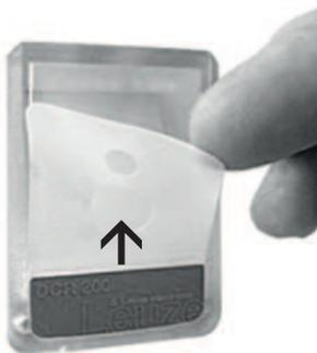
Figura 6.24: Colocar una lámina difusora
