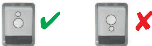
Figura 6.23: Orientación de la lámina difusora
