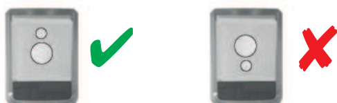
Figura 6.23: Orientamento del film diffusore
