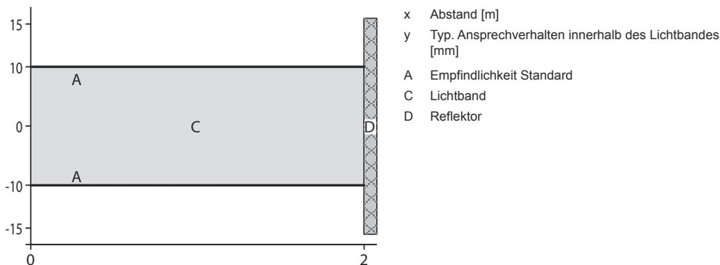
Referenzobjekt für Detektion: Ø 5 mm mit Reflektor TKS 100x100
